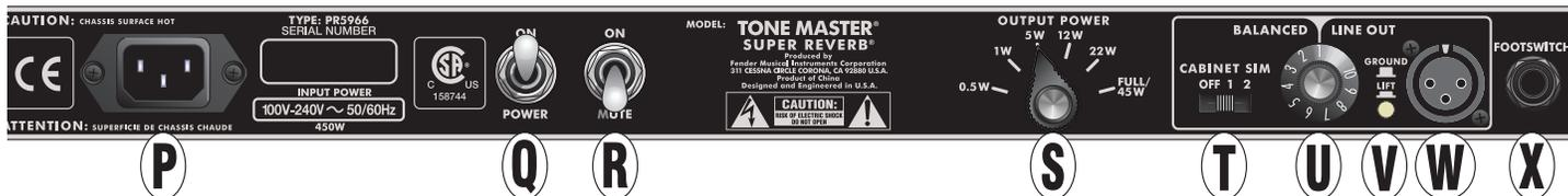
**P. CONECTOR DE ALIMENTACIÓN IEC:** Sirve para la conexión del cable de alimentación suministrado a una toma eléctrica con toma de tierra cuya tensión eléctrica y frecuencia de red responda a los valores indicados en el conector. Conexión universal para funcionamiento en un rango de 100V a 240V.
