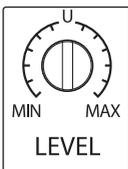
**Control Level:** Ajusta la cantidad de ganancia aplicada a la entrada de señal. Esto no es un control de volumen en el sentido tradicional, sino que ajusta el nivel de la señal de entrada antes de ser amplificada.
