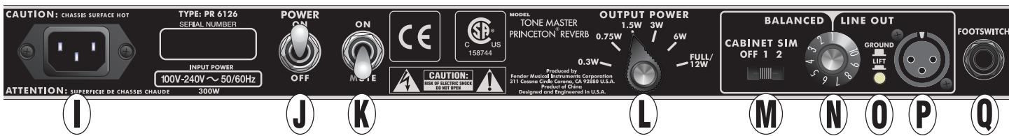
**I. ENTRADA ENERGIA IEC:** Conecte aqui o cabo incluso a uma tomada A/C aterrada de acordo com a classificação de voltagem e frequência especificadas perto da entrada. Fonte de alimentação universal para operação dentro de 100V a 240V.
