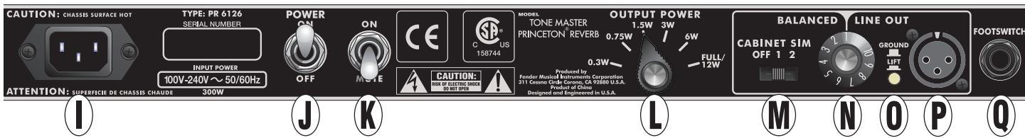
**I. ENTRADA ENERGÍA IEC:** Conecte aqui o cabo incluso a uma tomada A/C aterrada de acordo com a classificação de voltagem e frequência especificadas perto da entrada. Fonte de alimentação universal para operação dentro de 100V a 240V.
