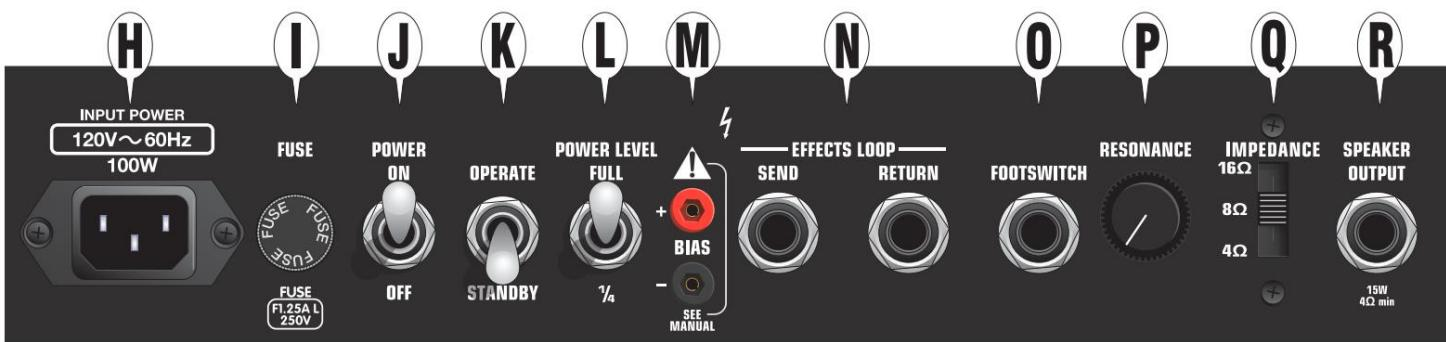
H. ULAZ NAPAJANJA: Spojite priloženi kabel za napajanje na a uzemljenu utičnicu u skladu s vrijednostima napona i frekvencije navedenim na stražnjoj ploči pojačala.
