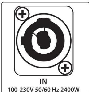
AC priključak. Zvučnici serije CDL imaju univerzalno napajanje koje prihvataju ulaz izmjenične struje između 100 i 250 VAC pri 50/60 Hz. Svaki zvučnik se isporučuje s AC powerCON® kabelom za napajanje koji odgovara zemlji prodaje.
