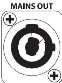
AC priključak. CDL zvučnici imaju raspon napona od 100-120VAC, ili 220-240VAC, 50-60Hz.
