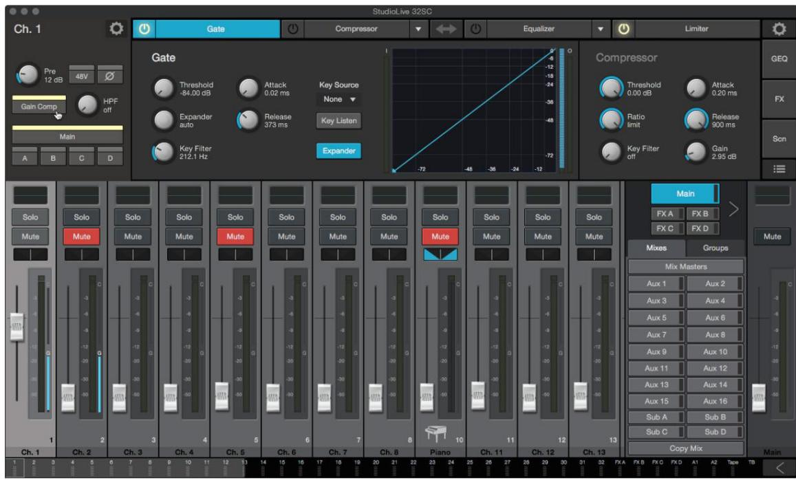
Napomena: Ako ne omogućite kompenzaciju pojačanja, napravite promjenu na mikseru s kontrolom prepojačala NSB stage box će to promijeniti za bilo koji uređaj koji sluša taj stream na mreži.
