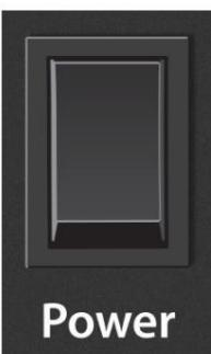
Prekidač za napajanje. Ovo je prekidač za uključivanje/isključivanje vašeg NSB-a.
