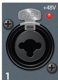
Mikrofonski/linijski ulazi. Ulazi na vašem NSB-Stageboxu također mogu prihvati signale na razini mikrofona ili linije. Ovi ulazi koriste TRS-XLR kombinirane priključke koji mogu prihvati i XLR i balansirane ili nebalansirane 1/4" kabele.
