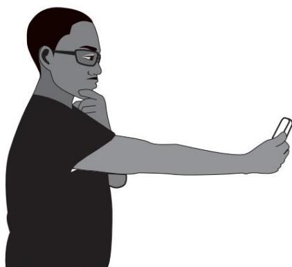
SPL mjerač treba držati ispružene ruke, s mikrofonom usmjerenim u središnju točku između lijevog i desnog zvučnika (gdje će vam biti glava), pod kutom od 45 stupnjeva kako bi se osiguralo točno očitanje. Ako je vaš SPL mjerač ujedno i vaš mobilni telefon, provjerite da vaš prst ili torbica za mobitel ne prekrivaju mikrofon!
