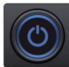
Gumb za uključivanje i svjetlo za sinkronizaciju (samo STUDIO1824c). Svjetleći prsten oko tipke za napajanje vašeg STUDIO1824c indikator je izvora sata. Omogućuje vam da znate prima li vaša jedinica sat riječi ispravno. • Plava. Kada ovo svjetlo svijetli plavo, vaš STUDIO1824c je ili glavni sat vašeg sustava ili prima sat riječi iz određenog vanjskog izvora putem ADAT ili S/PDIF ulaza.
