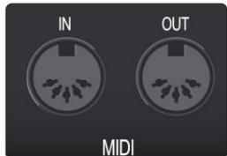
MIDI ulaz i izlaz. MIDI je kratica za "Digitalno sučelje glazbenih instrumenata". MIDI ulazi i izlazi omogućuju povezivanje i komunikaciju s vanjskom MIDI opremom. Jedna funkcija ovih priključaka je MIDI sekvenciranje, ali MIDI protokol može se koristiti za puno više od instrumenata i sekvenciranja.
