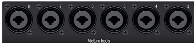
Mikrofonski/linijski ulazi (samo STUDIO1824c). Kombinirani priključci na stražnjoj ploči STUDIO1824c mogu se koristiti i za mikrofone i za uređaje na razini linije. Koristite XLR priključke za mikrofone i DI kutije i 1/4-inčne TRS ulaze za signale na razini linije do +18 dBFS. Kontrola trimanja na prednjoj ploči osigurava pojačanje za obje vrste ulaza.
