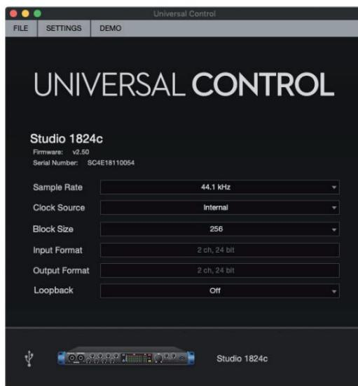
Uzorak stope. Mijenja stopu uzorkovanja. Brzinu uzorkovanja možete postaviti na 44,1, 48, 88,2, 96, 176,4 ili 192 kHz. Veća brzina uzorkovanja povećat će vjernost snimke, ali će povećati veličinu datoteke i količinu resursa sustava potrebnih za obradu zvuka.
