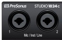
Mikrofon/instrumenti/linijski ulazi. Vaše sučelje serije Studio opremljeno je mikrofonskim prepojačalima PreSonus XMAX za korištenje sa svim vrstama mikrofona. XMAX ima ulazni međuspremnik klase A, praćen dvostrukim servo pojačanjem. Ovaj raspored rezultira ultra niskim šumom i širokom kontrolom pojačanja, što vam omogućuje pojačavanje signala bez povećanja pozadinske buke.
