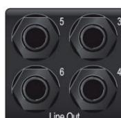
Linijski izlazi. Ovi uravnovešeni 1/4-inčni TRS linijski izlazi mogu se koristiti za usmjeravanje zvuka na vanjske uređaje, kao što su pojačala za slušalice, procesori signala i dodatni monitori. STUDIO1824c: Prva dva izlaza dijele svoje streamove reprodukcije s glavnim izlazima i slušalicom 1. Izlazi 3 i 4 dijele svoje streamove reprodukcije sa slušalicama 2 za STUDIO1824c i STUDIO1810c. Svi ostali izlazi imaju vlastite neovisne tokove reprodukcije.
