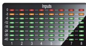
Ulazni mjerači. Ovi LED mjerači pokazuju ulaznu razinu analognih ulaza na sučelju vaše serije Studio. Crveni Clip LED će zasvjetliti kada vaš ulazni signal dosegne -0,5 dBFS. Na ovoj razini, signal će početi preopteretiti analogno-digitalne pretvarače i pokazivati znakove izrezivanja. Koristite kontrole pojačanja kako biste signal zadržali ispod ove razine.
