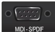
MIDI i S/PDIF priključak kabelskog priključka (STUDIO68c). Ovo je mjesto gdje spajate prekidni kabel za MIDI i S/PDIF I/O.
