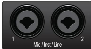
Ulazi za mikrofon. Vaše sučelje serije Studio opremljeno je visokokvalitetnim mikrofonskim prepojačalima za korištenje sa svim vrstama mikrofona. STUDIO26c ima XMAX-L solid-state mikrofonska prepojačala koja su optimizirana za napajanje sabirnice. STUDIO68c ima XMAX mikrofonska prepojačala s ulaznim međuspremnikom klase A, nakon čega slijedi dvostruki servo stupanj pojačanja.
