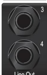
Linijski izlazi. Ovi 1/4-inčni, uravnoteženi linijski izlazi omogućuju vam usmjeravanje na vanjske uređaje, kao što su pojačala za slušalice, procesori signala i dodatni monitori. Svaki izlaz ima neovisni tok reprodukcije (streamovi reprodukcije 3 i 4).
