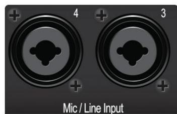
Mikrofonski/linijski ulazi (STUDIO68c). Ovi kombinirani konektori za mikrofon/liniju koriste se s mikrofonima na XLR ulazu i s uređajima na razini linije preko 1/4-inčnih TRS priključaka.
