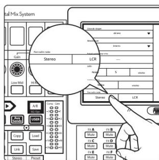
3. Iz ovog izbornika možete se prebacivati između Stereo Pan Mode i LCR Pan način rada.
