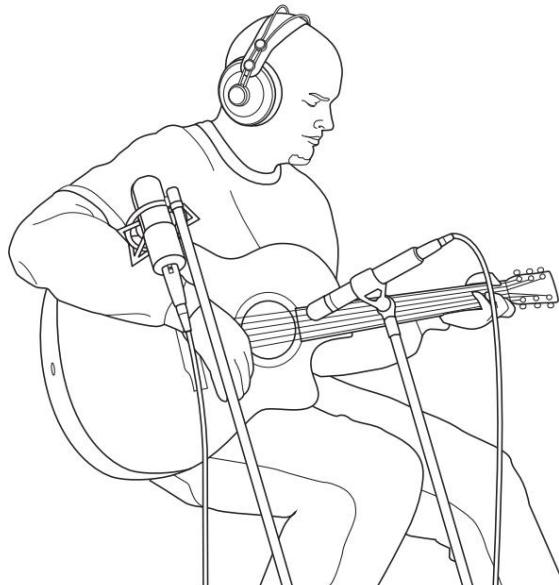
Usmjerite kondenzatorski mikrofon s malom dijafragmom na 12. prag, otprilike 8 inč a dalje. Usmjerite kondenzatorski mikrofon velike dijafragme prema mostu gitare, otprilike 12 inč a od gitare. Eksperimentirajte s udaljenostima i položajem mikrofona. Druga popularna metoda je korištenje XY položaja mikrofona s dva kondenzatorska mikrofona s malom dijafragmom.
