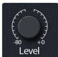
Kontrole glavne/mono razine (32-kanalni modeli). Svi 32-kanalni modeli miksera StudioLive opremljeni su kontrolom razine za podešavanje izlazne razine na analognom stupnju. Kontrola prigušenja glavnog (stereo) izlaza ima raspon od -80 do 0 dB. Mono izlazna razina ima raspon od -80 do +6 dB.
