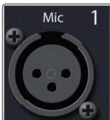
Ulazi samo za mikrofon. Svaki model mikseta StudioLive Series III, osim StudioLive 64S, takođe ima ulaz samo za mikrofon. Ovi se ulazi mogu koristiti samo s izvorima na razini linije spojenim na DI box.
