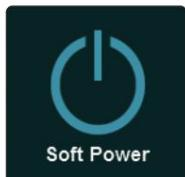
Kada isključite mikser, imate mogućnost uključiti Soft Power. Ovo će automatski aktivirati Autostore za spremanje svih postavki miksera prije isključivanja kada se odabere "Confirm Power Off". Također ćete dobiti opciju da se odjavite iz trenutnog korisničkog profila.
