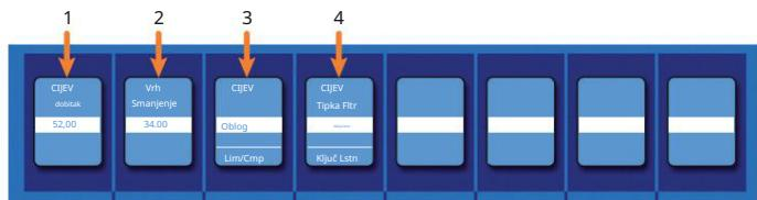
1. Dobitak. Postavlja pojačanje ulaza na kompresor. Budući da ovaj tip kompresora radi na drugačiji način od standardnog kompresora, velik dio načina na koji utječe na signale temelji se na ulaznoj razini. Isprobajte različite postavke kako biste vidjeli što odgovara vašim potrebama.
