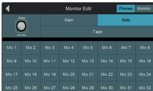
Na ovom zaslonu možete odabrati koje ćeete signale poslati na izlaze za monitor i slušalice. Dodirnite gumb Monitor za konfiguriranje usmjeravanja signala za izlaze monitora.
