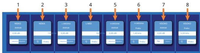
1. Pojas 1 / niski dobitak. Postavlja iznos za koji će odabrana frekvencija biti pojačana ili smanjena. Pritisnite donji gumb za uključivanje ili isključivanje trake.
