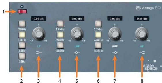
1. EQ On/Off. Globalno omogućuje/onemogućuje EQ. Dodirnite za uključivanje ili isključivanje.
