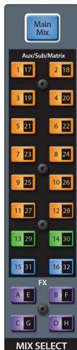
Mikseri StudioLive serije III pružaju FlexMixe koji se mogu koristiti za razne primjene. StudioLive 64S opremljen je s 32 FlexMixa; svi ostali modeli opremljeni su sa 16. Bez obzira na model, svi FlexMixes funkcioniraju na potpuno isti način i mogu se konfigurirati na sljedeći način:
