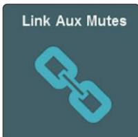
Pritiskom na gumb Link Aux Mutes iz izbornika System omogućuje vam odabir između četiri načina povezivanja koji odabiru način na koji će utišavanja kanala i Aux send isključiti interakciju:
