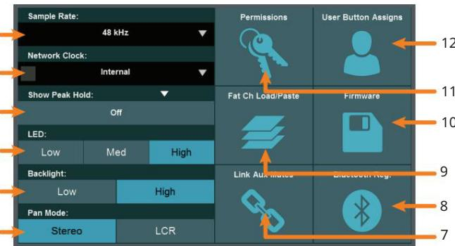
1. Stopa uzorkovanja. Postavlja brzinu uzorkovanja miksera. StudioLive Series III mikseri mogu raditi na 48 kHz ili 44,1 kHz.
