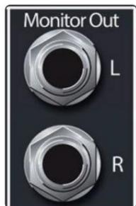
Izlazi monitora. Ovaj par balansiranih 1/4" TRS izlaza predviđen je za povezivanje para monitora u kontrolnoj sobi ili zvučnoj kabini. Razina se kontrolira gumbom Monitor u odjeljku Monitori na gornjoj ploči.
