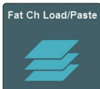
Da biste odabrali koje se vrste postavki parametara Fat Channel primjenjuju kada učitate unaprijed postavljene postavke Fat Channel ili kopirate i zaliđepite postavke Fat Channel između kanala, dodirnite gumb Fat Channel Load/Paste na izborniku System.
