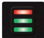
Svaki kanal ima trosegmentni LED mjerač razine za indikaciju razine signala. Donji segment svijetli kada signal dosegne -40 dBFS. Srednji segment svijetli kada signal dosegne -18 dBFS. Gornji segment će početi svijetliti crveno kako se ulazni signal približava isječku na -1,5 dBFS. Nakon što signal prijeđe -0,2 dBFS, LED će svijetliti jače.
