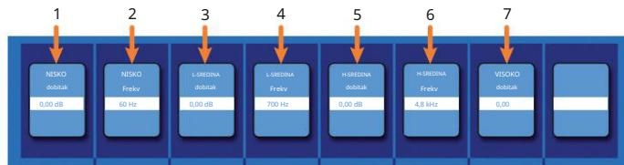
1. Nizak dobitak. Postavlja količinu pojačanja ili smanjenja za primjenu niskofrekventnog pojasa ovaj EQ.
