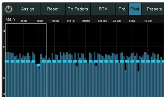
Svaki grafički EQ opremljen je analizatorom u stvarnom vremenu ili RTA, u kojem je x = frekvencija i y = amplituda. Kao što je ranije spomenuto, RTA pruža blizak vizualni prikaz onoga što čujete. Omogućuje pogled na dugoročni spektar signala—na primjer, dugoročni prosjek spektra jedne trećine oktave glazbene izvedbe.
