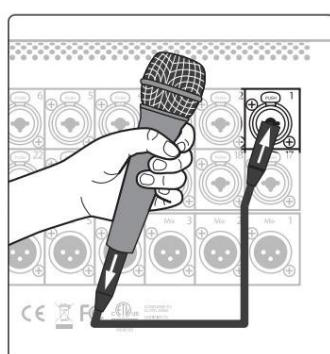
1. Uključite mikrofon u ulaz Channel 1 na vašem StudioLive Series III standardnim XLR kabelom.
