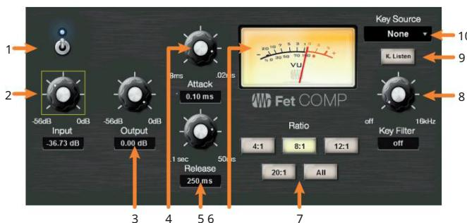
1. Uključivanje/isključivanje procesora. Omogućuje ili onemogućuje kompresor.
