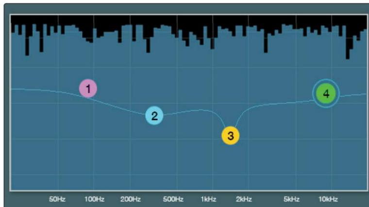
Standardni EQ opremljen je analizatorom u stvarnom vremenu ili RTA, u kojem je  $x =$  frekvencija i  $y =$  amplituda. RTA pruža i blizak vizualni prikaz onoga što čujete jer je to prikaz sadržaja amplitude i frekvencije u određenoj ravnini u stvarnom vremenu. Omogućuje pogled na dugoročni spektar signala—na primjer, dugoročni prosjek spektra jedne trećine oktave glazbene izvedbe.
