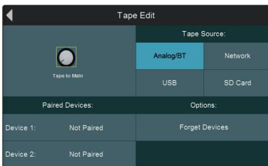
Prikazuje se zaslon za uređivanje trake. Ovdje možete odabrati signal koji će se usmjeriti na ulazni kanal trake između sljedećih opcija:
