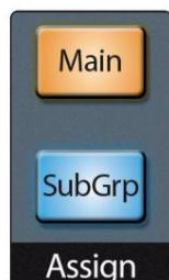
Kada je odabran ulazni kanal, pomoću ovih gumba možete ga dodijeliti izlaznom putu. Pritisnite Main za slanje izlaza odabranog kanala na glavnu sabirnicu. Pritisnite SubGrp za otvaranje zaslona za dodjelu sabirnice na dodirnom zaslonu.
