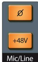
Kada je odabran analogni ulazni kanal, ove tipke vam omogućuju uključivanje ili isključivanje promjene polariteta kanala ( $\emptyset$ ) i fantomskog napajanja (+48 V).
