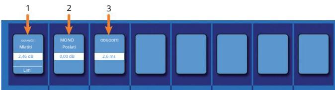
1. Prag ograničenja. Ovaj koder postavlja, a traka za škrabanje prikazuje prag limitera za odabrani kanal ili izlaznu sabirnicu. Kada je signal amplituda (razina) premašuje postavku praga, limiter je uključen. Okretanje gumba u smjeru suprotnom od kazaljke na satu snižava prag, tako da ograničenje počinje na nižem amplitudu. Omjer ograničenja je 1:1.
