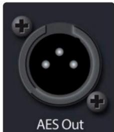
AES izlaz. Prema zadanim postavkama, AES/EBU digitalni izlaz prima isti signal kao i glavni stereo izlazi. Međutim, možete usmjeriti bilo koju od mix sabirnica, ulaz trake ili Solo bus do ovog izlaza. Budući da se StudioLive ne može eksterno sinkronizirati, vi hoćete morate ga koristiti kao glavni sat i postaviti svoj uređaj opremljen AES-om da prima riječ sat eksterno putem AES-a. Pogledajte dokumentaciju za vaš vanjski digitalni uređaj uređaj za upute.
