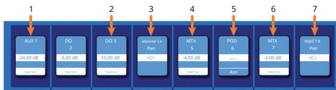
1. Mono pom. Koder kontrolira razinu slanja kanala na Mono Aux. Gumb ispod upravlja isključivanjem kanala u Mono Aux.
