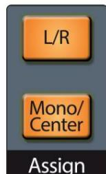
Kada je odabran ulazni kanal, možete upotrijebiti ove gume da ga dodijelite glavnoj i mono/središnjoj sabirnici. Pritisnite L/R za slanje izlaza odabranog kanala na glavnu stereo sabirnicu. Pritisnite Mono/Center za slanje izlaza kanala na Mono ili Center sabirnicu (ovisno o Pan Mode).
