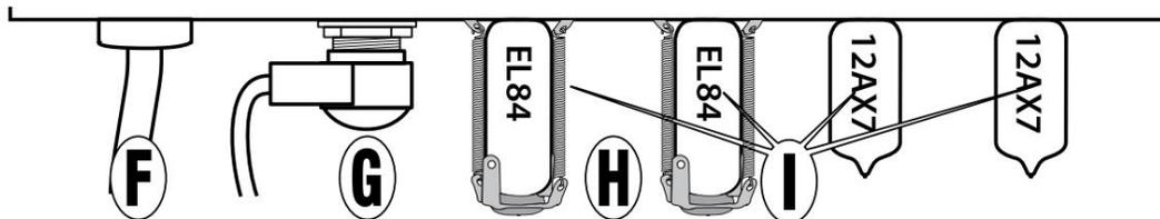
**F. KABEL ZA NAPAJANJE:** Spojite ga na uzemljenu utičnicu u skladu s vrijednostima napona i frekvencije navedenim na stražnjoj ploči vašeg pojačala.
