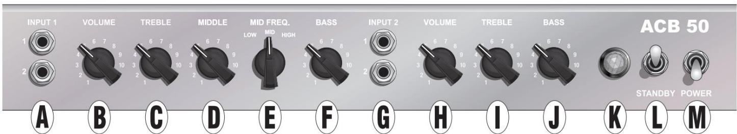
A. KANAL JEDAN DVOSTRUKI ULAZ: Ovdje spojite instrument. Ulaz 1 je za normalnu osjetljivost; ulaz 2 ima nižu osjetljivost (-10dB) za jače (aktivne) basove.
