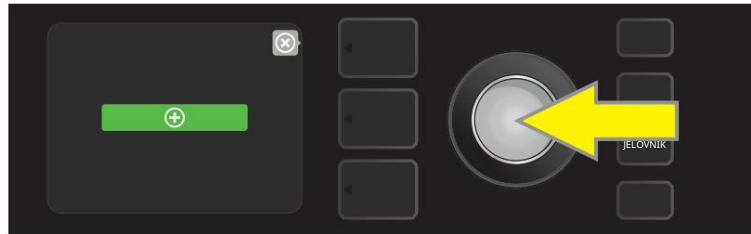
Upotrijebite ENCODER za pomicanje između unaprijed postavljenih postavki za dodavanje na SETLIST 1, zatim pritisnite ENCODER za odabir željene unaprijed postavljene postavke:
