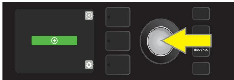
Pojavit će se plavi okvir s oznakom "SETLIST 1"; pritisnite ENCODER na SETLIST 1 za početak dodavanja unaprijed postavljenih postavki:
