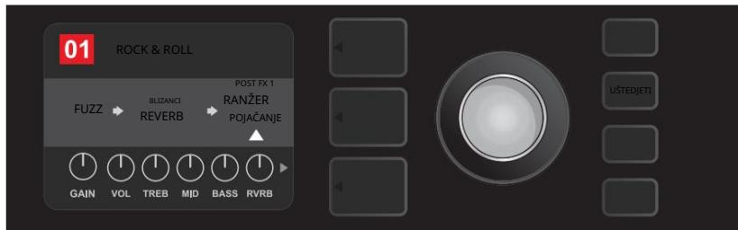
Sa zamijenjenim efektom (kao što je ovdje naznačeno bijelom strelicom ispod njega i oznakom iznad njega), nastavite uređivati druge parametre ili pritisnite osvijetljeni gumb SAVE uslužnog programa da zadržite dovršena uređivanja.
