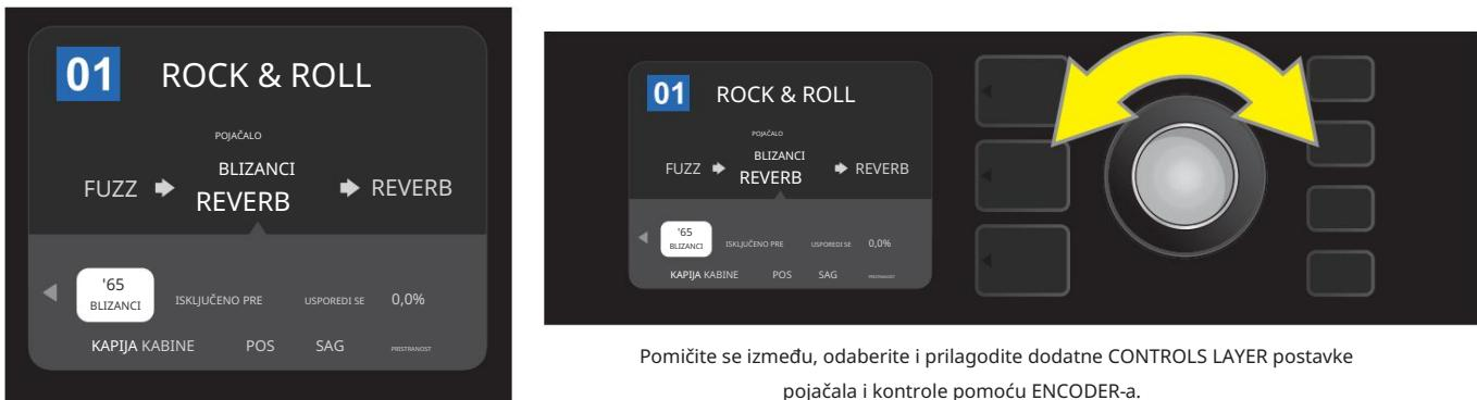
Detalj izbliza koji prikazuje dodatne postavke pojačala i kontrole koje se nalaze u SLOJU KONTROLA; u ovom slučaju za model pojačala Twin Reverb.
