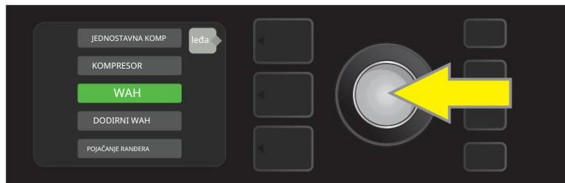
Odaberite efekt pomicanjem do njega i pritiskom na ENCODER.
