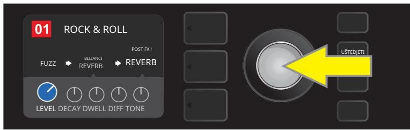
Pritisnite ENCODER za zadržavanje uređene postavke kontrole efekta; kontrola učinka vratit će se na plavu.
