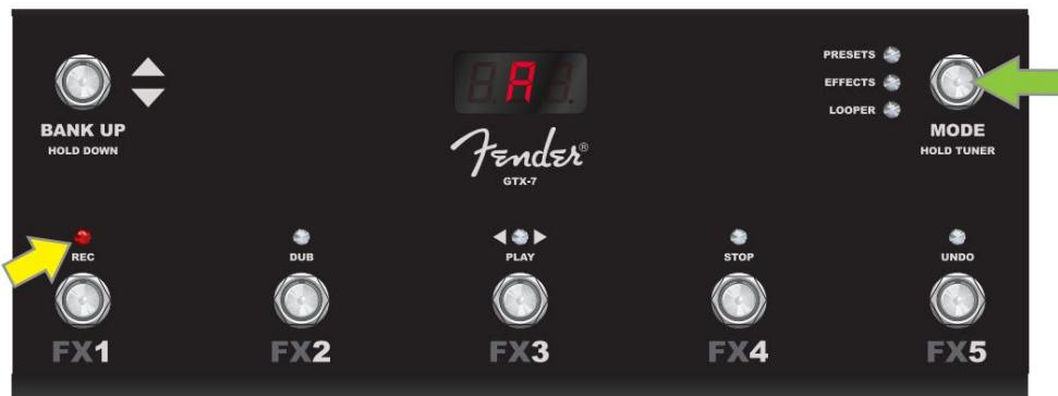
Za aktiviranje funkcije ugađanja nožnog prekidača GTX-7 pritisnite i kratko držite gumb MODE (zelena strelica). U ovdje prikazanom primjeru, nota "A" prikazana je kao posebno ravna, što je naznačeno osvjetljenjem FUNCTION LED 1 krajnje lijevo (žuta strelica).
