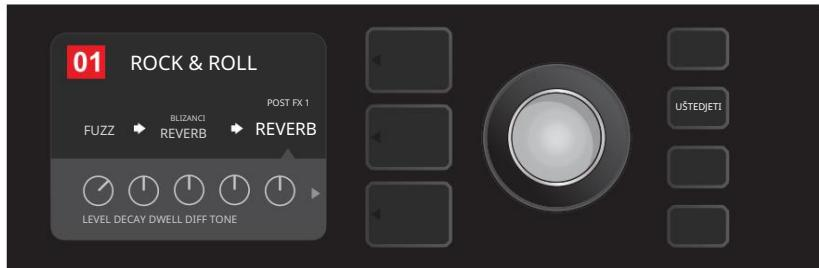
S određenom kontrolom efekta uređenom prema želji, nastavite s uređivanjem ostalih parametara ili pritisnite osvijetljeni gumb SAVE kako biste zadržali dovršene izmjene.
