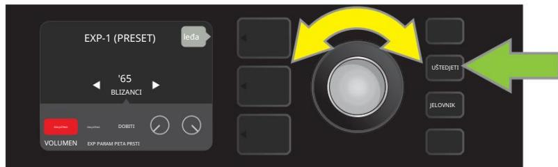
Okrenite ENCODER (žuta strelica) na "OFF", zatim ga pritisnite za odabir postavke "OFF". EXP-1 Funkcija pedale za način rada glasnoće za pojačalo prikazano u SLOJU PUTA SIGNALA sada je isključena, a okvir s oznakom ponovno će biti plav. Pritisnite tipku SAVE (zelena strelica) za zadržavanje promjena.
