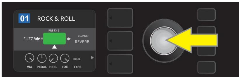
Nakon pomicanja novododanog efekta okretanjem DAVAČA, pritisnite DAVAČ kako biste odabrali njegovu novu poziciju u putanji signala.
