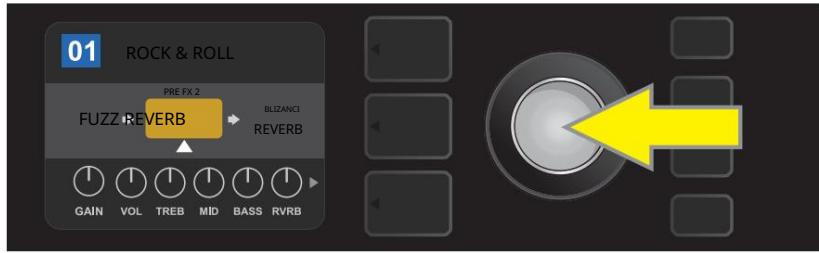
Nakon pomicanja odabranog efekta okretanjem ENCODER-a, pritisnite ENCODER kako biste odabrali njegovu novu poziciju u putanji signala.
