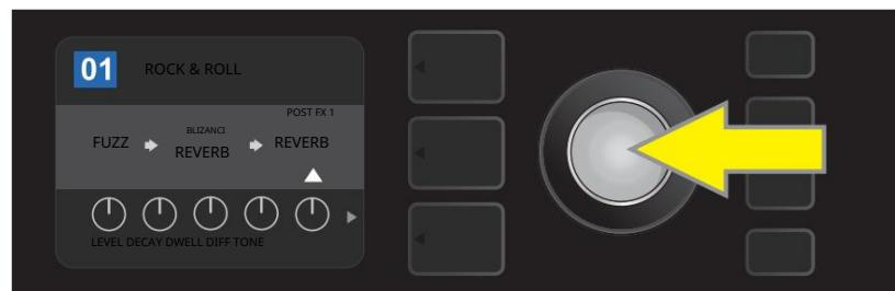
Na drugi način za dodavanje efekta, označite postojeći efekt unutar unaprijed postavljene postavke tako da okrenete ENCODER prema njemu i pritisnete ENCODER da vidite izbornik od četiri kategorije efekata.
