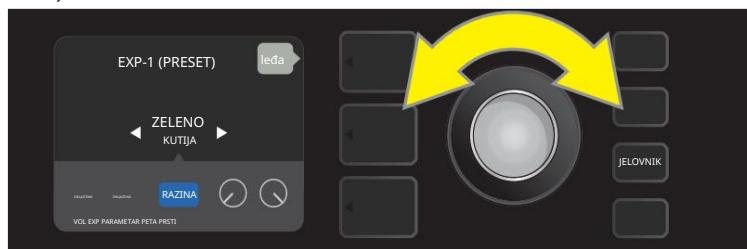
Upotrijebite ENCODER (žuta strelica) za pomicanje do "PARAMETER", koji obuhvaća pojedinačne kontrole za učinak istaknut u SLOJU PUTO SIGNALA. U ovdje prikazanom primjeru, "LEVEL" je jedan od Green Box overdrive parametara koji se mogu dodijeliti EXP-1.
