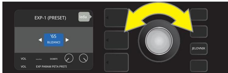
U EXP-1 PRESET SETTINGS, pojačalo i efekti u unaprijed postavljenoj postavci kojoj se EXP-1 može dodijeliti prikazani su jedan po jedan u SLOJU PUTA SIGNALA; ENKODER se koristi za listanje kroz njih. U gornjem primjeru istaknuto je Twin pojačalo iz '65.
