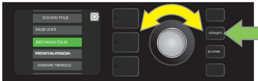
Za pregled ili uređivanje pojedinačnih sadržaja istaknute unaprijed postavljene postavke oblaka prije nego što je spremite u pojačalo kao što je gore opisano, pritisnite ENCODER na njemu (pogledajte ilustraciju u nastavku).
