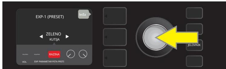
Iz gornjeg primjera pritisnite ENCODER (žuta strelica) na "LEVEL". Njegov će se okvir promjeniti iz plave u crvenu, što znači da se tada mogu izvršiti prilagodbe tog parametra pojačanja zelene kutije za korištenje EXP-1.
