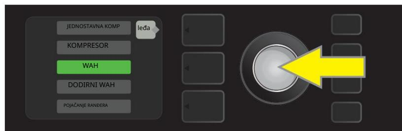
Odaberite efekt pomicanjem do njega i pritiskom na ENCODER.
