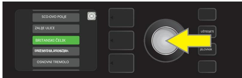
Kada pregledavate ili uređujete sadržaj unaprijed postavljene postavke u oblaku prije nego što je spremite na pojačalo, PROZOR ZASLON će prikazati sadržaj postavke zajedno sa zelenim simbolom "oblaka" (umjesto broja koji prati ugrađene postavke). Zeleni oblak označava unaprijed postavljenu postavku kao postavku u oblaku koja nije spremljena u pojačalo.
