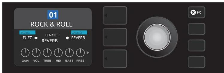
Gumb pomoćnog programa "X FX" svijetli kada se pritisne, zaobilazeći sve efekte u svim unaprijed postavljenim postavkama (kao što je naznačeno plavim oznakama "BYPASS" iznad svakog efekta).
