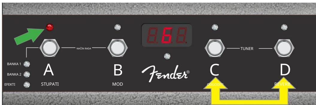
Kako biste aktivirali funkciju ugađanja nožnog prekidača, pritisnite tipke "C" i "D" istovremeno (dvostruka žuta strelica). U gornjem primjeru, nota "G" prikazana je kao posebno ravna, što je naznačeno osvjetljenjem crvenog LED-a iznad gumba "A" (zelena strelica).
