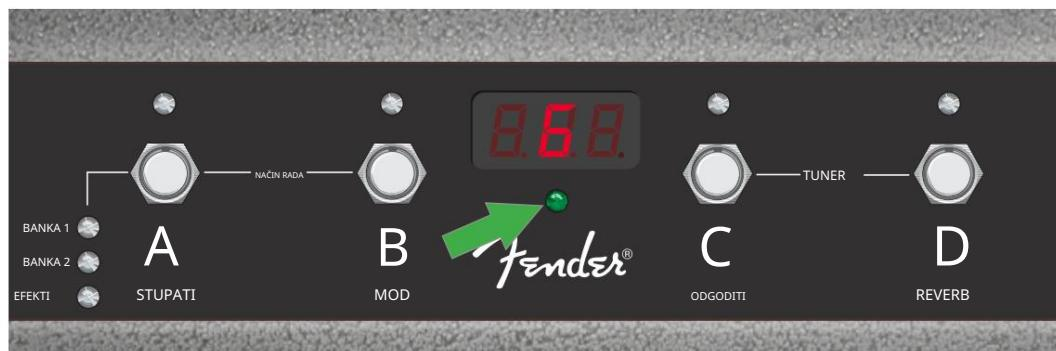
Ovdje je nota "G" na ispravnoj visini, kao što je naznačeno osvjetljenjem zelene središnje LED diode (zelena strelica). Kada je ugađanje završeno, pritisnite bilo koju tipku za izlaz iz moda tunera s nožnim prekidačem.
