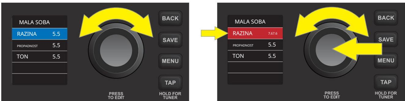
U ovom trenutku pritisnite ENCODER za prihvatanje podešene vrijednosti kontrole učinka i izlaz iz moda za uređivanje; okružujući okvir će se tada vratiti u plavo. Alternativno, pritisnite tipku BACK uslužnog programa (zelena strelica) za prihvatanje promjene vrijednosti kontrole efekta i povratak na zaslon unaprijed postavljenog sadržaja:
