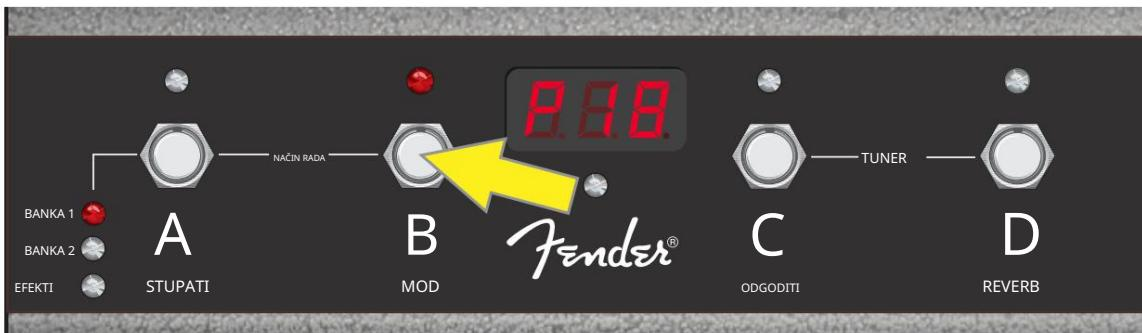
Za pristup unaprijed postavljenim postavkama u BANK 2, pritisnite tipke "A" i "B" istovremeno. Zelena LED lampica "BANK 2" krajnje lijevo će zasvjetliti, pokazujući da su četiri unaprijed postavljene postavke u BANCI 2 dodijeljene tipkama nožnog prekidača "A", "B", "C" i "D". Kao i prije, pritisnite gumb koji odgovara željenoj unaprijed postavljenoj postavci. U primjeru ovdje, unaprijed postavljena 5 ima
