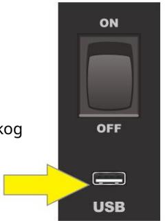
Imajte na umu da iako se USB priključak i pomoći ulaz mogu koristiti istovremeno, USB priključak se ne može koristiti za snimanje signala s pomoćnog ulaza. Također imajte na umu da je USB izlaz u stereo formatu i da će unaprijed postavljene kontrole pojačanja, glasnoće i tona utjecati na USB razinu i ton, dok kontrola MASTER VOLUME neće.
