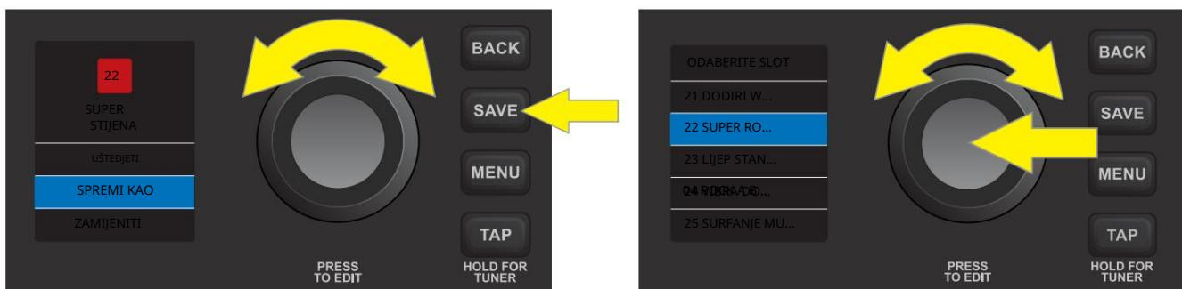
Bilo da mijenjate naziv unaprijed postavljene postavke ili ne kada koristite "SPREMI KAO", ime se mora unijeti pritiskom na ENCODER za aktiviranje pokazivača, a zatim sričanjem imena okretanjem i pritiskom ENCODER-a za pomicanje i odabir znakova. Svi se znakovi mogu obrisati korištenjem ENCODER-a za pomicanje i odabir "CLEAR ALL".
