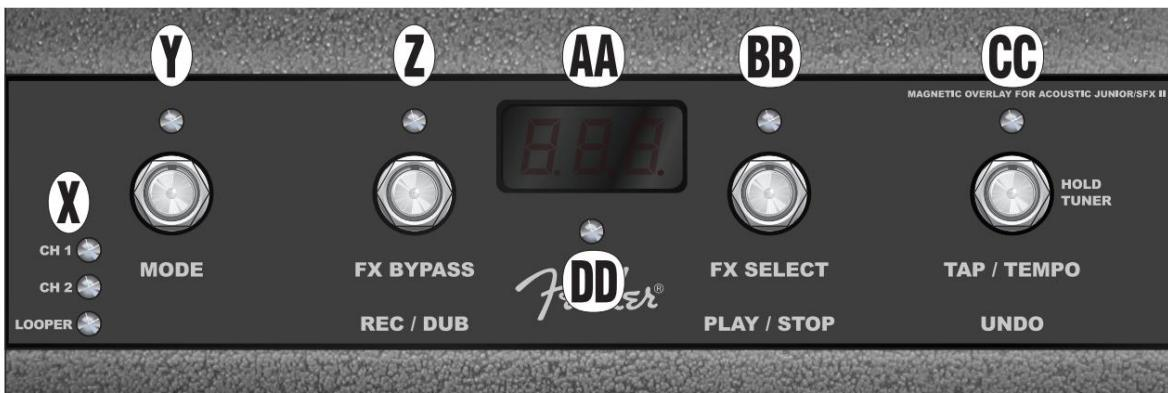
**ЗАБЕЛЕЖКА:** ТРЯБВА ДА БЪДЕ ПРИЛОЖЕН ЕТИКЕТЪТ С МАГНИТНО ПОКРИВАНЕ, ВКЛЮЧЕН В ОПАКОВКАТА НА УСИЛВАТЕЛЯ КЪМ ОПЦИОНАЛНИЯ КРАЧЕН ПРЕВКЛЮЧВАЧ MGT-4 С ЧЕТИРИ БУТОНА, ЗА ДА СЕ ИЗПОЛЗВА КРАЧНИЯ ПРЕВКЛЮЧВАТЕЛ С ТЕЗИ УСИЛВАТЕЛИ. ПРОСТО ПОСТАВЕТЕ МАГНИТНИЯ ЕТИКЕТ ВЪРХУ КРАЧНИЯ ПРЕВКЛЮЧВАТЕЛ (НАСЛОЖЕНИЕТО Е ПОКАЗАНО НА МЯСТОТО ПО-ГОРЕ).
