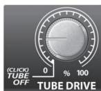
Tube Drive. Tube Drive kontrolira glasnoću koja se usmjerava kroz 12AX7 vakuumsku cijev, za razliku od Input Gain-a koji kontrolira ukupnu glasnoću. Postignuti učinak varira od suptilnog do ekstremnog, ovisno o postavci koja se koristi. Što je više signala poslano u cijev, to ćeće čuti više izobličenja. Iako nećete uvijek htjeti koristiti cijevni pogon, on može biti izvrstan izbor za gitaru, bas pa čak i vokale.
