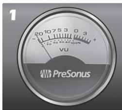
VU mjerač. Analogni VU prikazuje izlaznu razinu vašeg BlueTube DP V2.
