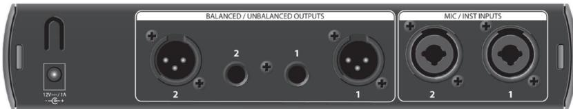
Ulazi za mikrofon. Vaš BlueTube DP V2 opremljen je mikrofonskim prepojačalima PreSonus XMAX za korištenje sa svim vrstama mikrofona.
