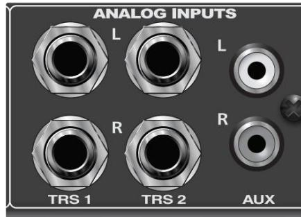
Ovi ulazi su za vaše audio izvore (mikser, audio sučelje, CD player, itd.). Prilikom spajanja balansiranih TRS ulaza vaše centralne stanice na ove uređaje treba koristiti samo balansirane kabele. Zbog Glavnog kolodvora pasivni strujni krugovi, korištenje neuravnoteženih kabela može smanjiti izlaznu razinu i unijeti šum u vaš sustav.
