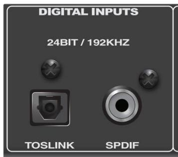
Central Station automatski čita i zaključava brzinu uzorkovanja dolaznog digitalnog toka te može primati i zaključati brzinu uzorkovanja od 44,1, 48, 96 i 192 kHz. Oba ova digitalna ulaza dizajnirana su za S/PDIF stereo digitalni format.
