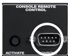
1. Spojite jednu stranu priloženog DB15 kabela na stražnju stranu CSR-1 a drugu stranu na priključak konzole na stražnjoj strani vaše centralne stanice. Imajte na umu da DB15 kabel ima vlasnički pin-out; izgleda kao standardni VGA kabel, ali je drugačije ožičen. Ako trebate zamjenski kabel, morat će ga naručiti s [www.PreSonus.com](http://www.PreSonus.com).
