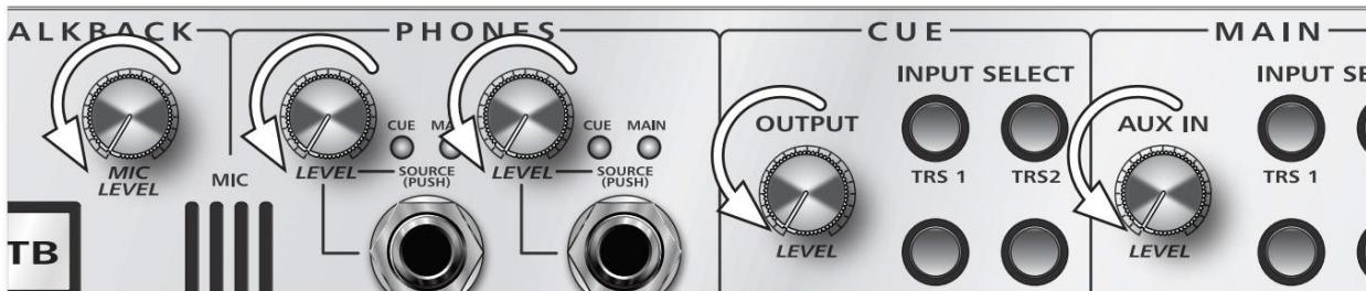
5. Okrenite sljedeće kontrole do kraja u smjeru suprotnom od kazaljke na satu: razina Talkback mikrofona, razina slušalica, izlazna razina, pomoćna ulazna razina i glavna izlazna razina.
