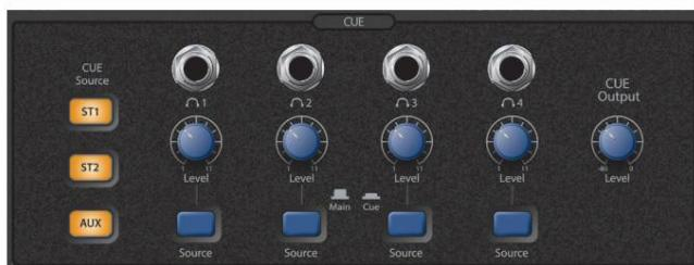
Odjeljak Cue na prednjoj ploči omogućuje vam upravljanje Cue sustavom Monitor Station V2 i kontrolu njegova četiri pojedinačno kontrolirana izlaza za slušalice. Svaki izlaz ima vlastiti birač ulaza i vlastitu kontrolu glasnoće.
