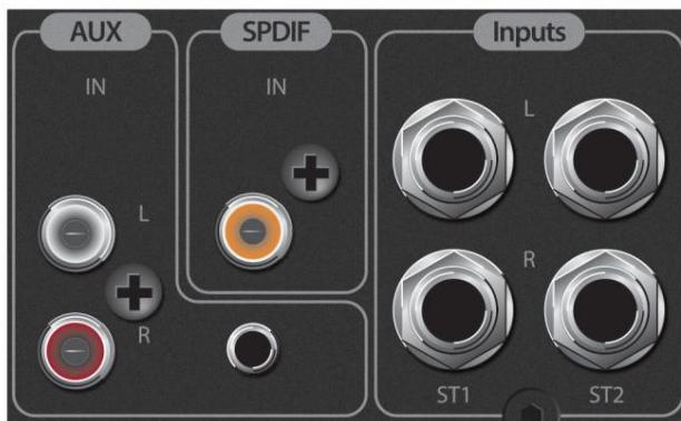
ST1 L/R: Spojite lijevi i desni kanal vašeg primarnog stereo izvora na ove uravnotežene ¼" TRS priključke.
