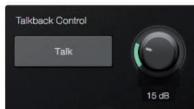
Pritisnite gumb Talkback da omogućite funkciju Talk na svom Quantumu. Tada možete uključiti Talkback mikrofon u bilo kojem miksu iz vašeg DAW-a.
