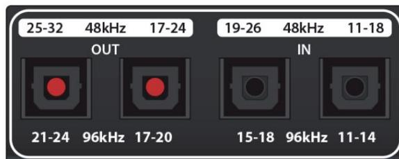
ADAT – S/MUX ulaz i izlaz. Ovo su ADAT – Dual S/MUX veze za vaše vanjske digitalne uređaje. Prilikom snimanja ili reprodukcije na 44,1 ili 48 kHz, svaki ADAT I/O će osigurati 8 od 16 dostupnih kanala uzastopno, s lijeva na desno. Prilikom snimanja ili reprodukcije na 88,2 ili 96 kHz, svaka će veza omogućiti četiri od osam dostupnih kanala.
