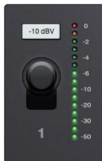
Kada je 1/4-inčni TRS kabel spojen na ulaze vašeg sučelja serije Quantum, dobit ćete prekidač za uključivanje osjetljivosti ulaza. Standardno je ulazna osjetljivost postavljena na +4 dBu. Većina profesionalnih uređaja na razini linije daje izlaz na ovoj razini. Razina potrošačke linije obično je -10 dBV. Za ove uređaje s nižim izlazom, prebacite ulaznu osjetljivost na -10 dBV kako bi odgovarala vašem uređaju.
