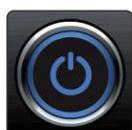
Gumb za uključivanje i svjetlo za sinkronizaciju. Osvijetljeni prsten oko gumba za uključivanje/isključivanje vašeg Quantuma indikator je izvora/sinkronizacije sata. Omogućuje vam da znate prima li vaša jedinica sat riječi ispravno.
