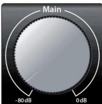
Glavni. Glavni gumb može kontrolirati bilo koji ili sve izlaze na stražnjoj ploči vašeg Quantuma i ima raspon od -80 dB do 0 dB. Osim kontrole razine, glavni izlazi imaju sljedeće kontrole:
