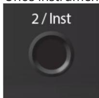
¼-inčni priključci kanala 2 mogu se koristiti s pasivnim instrumentima: gitara, bas, itd.
