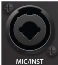
**Ingresso microfono/strumento.** Il canale 1 dell'interfaccia Revelator io44 è dotato di a presa combinata. Questo comodo connettore accetta una connessione TS da ¼ di pollice per sorgenti di strumenti ad alta impedenza come chitarre e bassi o un connettore XLR per microfoni professionali. Il preamplificatore microfonico a stato solido XMAX-L della connessione XLR è ottimizzato per l'alimentazione del bus.
