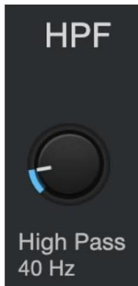
Utilizzare questo controllo per impostare la soglia di frequenza del filtro passa-alto per il canale o il bus di uscita selezionato. La soglia del filtro può essere impostata da 24 Hz a 1 kHz. Quando la soglia è impostata sul punto più basso, il filtro è disattivato. La pendenza del filtro passa-alto è -12 dB/8va.
