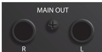
**Uscite principali.** Queste sono le uscite principali del Revelator io44. Il livello di uscita delle uscite Main è controllato dal controllo di livello Main sulla parte anteriore dell'unità. I flussi di riproduzione 1 e 2 vengono indirizzati a queste uscite.
