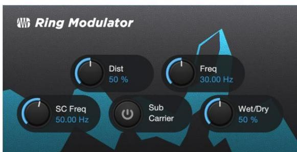
I **Dist**. Controlla la quantità di distorsione da zero a esagerata. I **IFreq** . Imposta la frequenza dell'oscillazione. I **SC Freq**. Imposta la frequenza della portante secondaria. I **Sottoportante**. Puoi scegliere di aggiungere o meno un'oscillazione a bassa frequenza al tuo segnale attivando o disattivando la portante secondaria.
