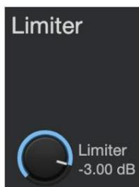
Questo encoder imposta la soglia del limitatore per il canale selezionato o il bus di uscita. Quando l'ampiezza (livello) del segnale supera l'impostazione della soglia, viene attivato il limitatore. Ruotando la manopola in senso antiorario si abbassa la soglia, quindi la limitazione inizia con un'ampiezza inferiore. Il rapporto del limitatore è  $\gamma:1$ .
