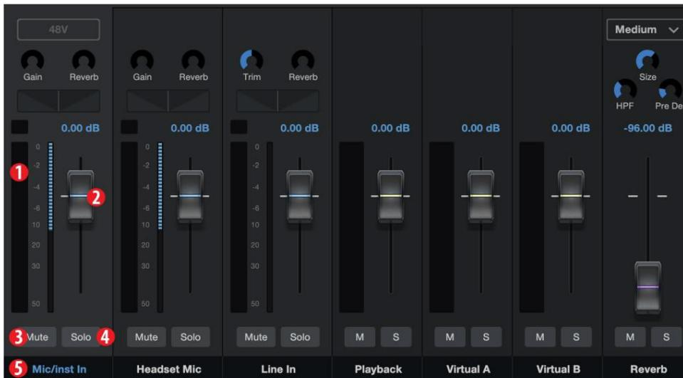
1. **Medidor de canal.** Este medidor exibe o nível atual do canal antes do nível do fader (#2).
