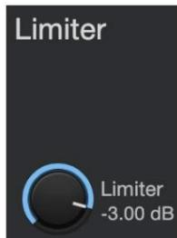
Este codificador define o limite do limitador para o canal ou barramento de saída selecionado. Quando a amplitude (nível) do sinal excede a configuração do limite, o limitador é acionado. Girar o botão no sentido anti-horário diminui o limite, de modo que a limitação começa em uma amplitude mais baixa. A relação do limitador é  $\gamma$ :1.
