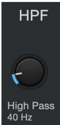
Use este controle para definir o limite de frequência do filtro passa-altas para o canal ou barramento de saída selecionado. O limite do filtro pode ser definido de 24 Hz a 1 kHz. Quando o limite é definido para o ponto mais baixo, o filtro está desligado. A inclinação do filtro passa-alta é de -12 dB/8va.
