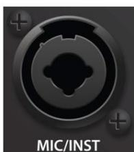
**Entrada de microfone/Inst.** O canal 1 da interface do Revelator io44 está equipado com um tomada combinada. Este conector conveniente aceita uma conexão TS de ¼ de polegada para fontes de instrumentos de alta impedância, como guitarras e baixos, ou um conector XLR para microfones profissionais. O pré-amplificador de microfone de estado sólido XMAX-L da conexão XLR é otimizado para alimentação de barramento.
