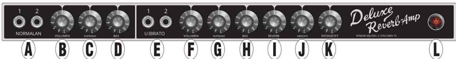
A. NORMALNI ULASI KANALA: Ovdje spojite instrument. Normalni ulaz 1 proizvodi punu osjetljivost; normalni ulaz 2 ima prilagođenu osjetljivost (-6dB) za nešto tamniji ton i čišći odziv s instrumentima s visokim pojačanjem.
