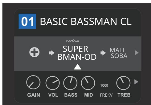
Model pojačala unutar unaprijed postavljenih postavki odabire se ovdje u SLOJU PUTA SIGNALA, kao što je naznačeno bijelom strelicom i riječju "pojačalo". Okružen je jednim zauzetim utorom za efekte (desno) i jednim praznim utorom za efekte (lijevo).
