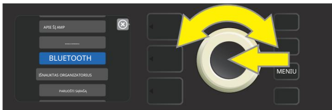
Naudodami ENCODER meniu slinkite iki „BLUE-TOOTH“, tada paspauskite ENCODER, kad pasiektumėte „Bluetooth“ nustatymus.
