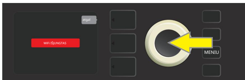
Numatytasis WiFi nustatymas yra "išjungtas" (pažymėtas raudonu langeliu); paspauskite ENCODER, kad įjungtumėte WiFi (pažymėtą žaliame langelyje).
