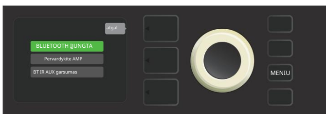
Numatytoji stiprintuvo Bluetooth funkcija yra "ON" (kaip pažymėta žaliame langelyje); išoriniame įrenginyje pasirinkite „RUMBLE“.
